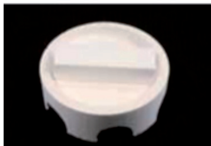
Bac de frittage avec bloc de frittage
