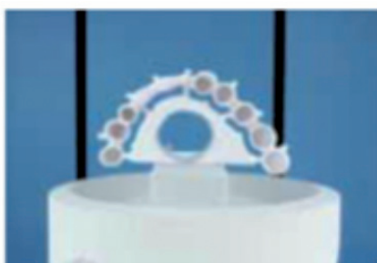
Správné umístění na sintrovací misce
