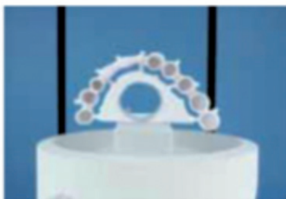
Ispravan položaj na plitici za sinteriranje
