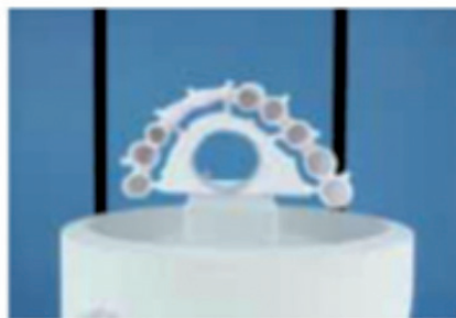
Pravilan položaj na tacni za sinterovanje
