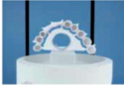
Sinterleme tepsisi üzerindeki doğru konum
