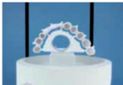
Posição correta na bandeja de sinterização
