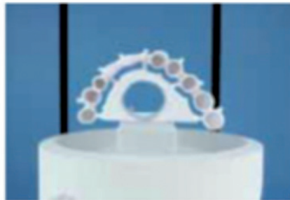
Korrekt position på sintringsbrickan
