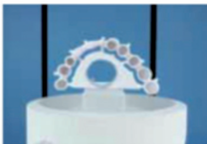
Ispravna pozicija na tacniza sinteriranje
