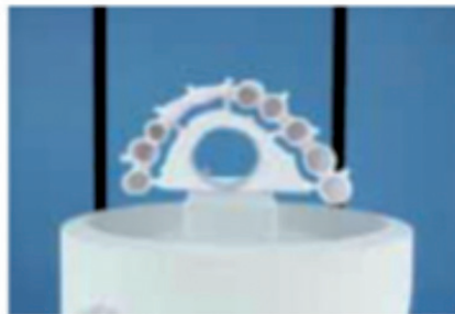
Richtige Positionierung auf der Sinterunterlage
