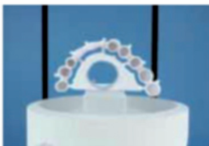
Korrekt placering på sintringsbakken
